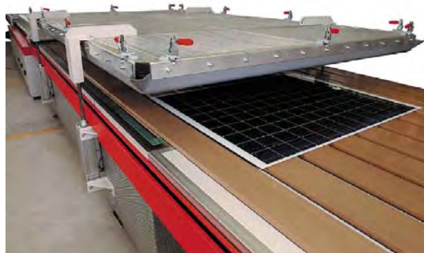
Συναρμολόγηση φωτοβολταϊκών πλαισίων (Στάδιο 3)
