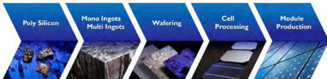
Η διαδικασία παραγωγής κρυσταλλικών φωτοβολταϊκών
