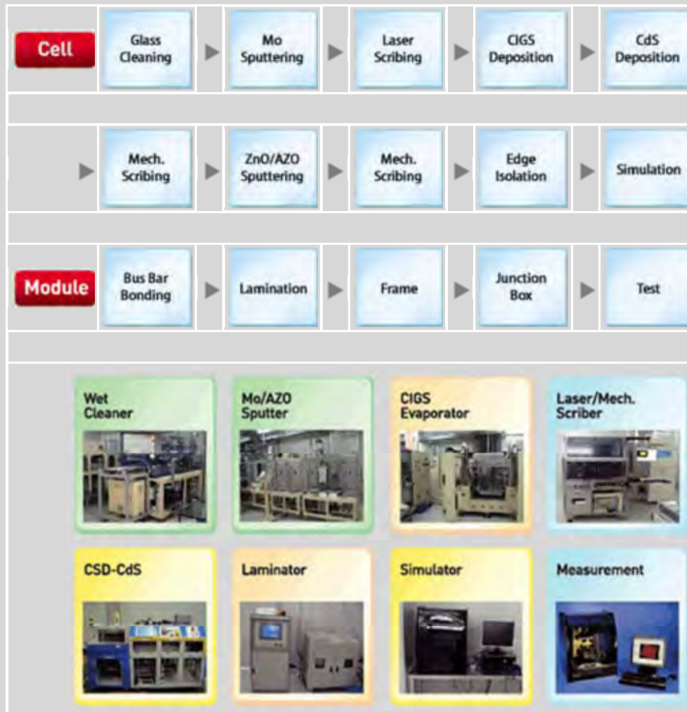
Στάδια παραγωγής φωτοβολταϊκών thin film τεχνολογίας CIGS
